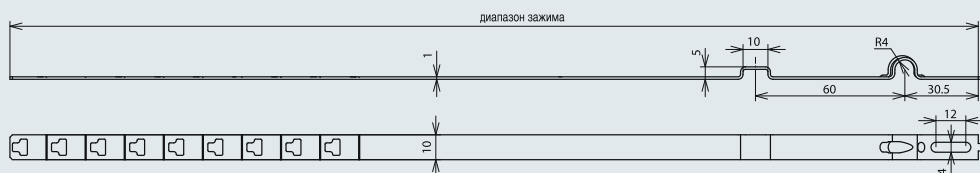
без винта, с гофрированной лентой, монтаж с помощью клещей для затягивания
