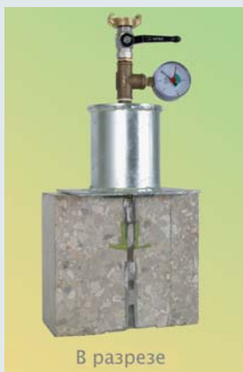
Рис. 2: Конструкция для испытания вводов под давлением
